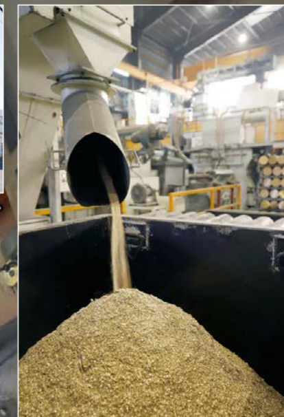
関工場から車で約20分の場所にある美山工場では、金属製品加工時に出る粉を溶鉱炉で溶かして再利用するための作業が行われている。
