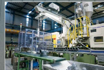
原材料の投入から部品の成形までを自動で行う射出成形機。別途供給される継手との接合も、自動で行われる。
