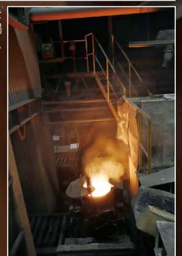
スクラップを溶かし原材料の配合比を調整することにより、マリアブル溶湯やダクタイル溶湯を製造する溶解工場。高周波電気炉を4基有する。
