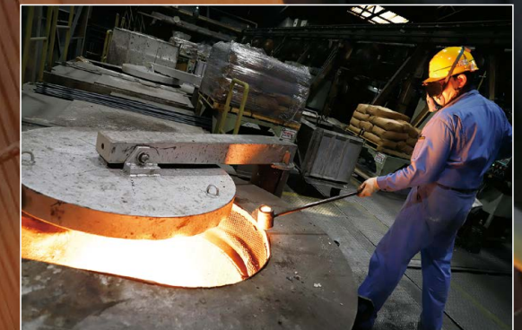
スクラップを溶かし原材料の配合比を調整することにより、マリアブル溶湯やダクタイル溶湯を製造する溶解工場。高周波電気炉を4基有する。
