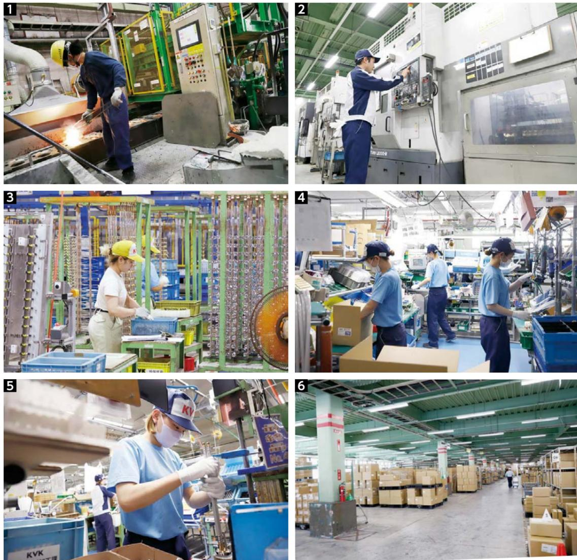
本社工場では、水栓本体を鋳造から製造している。品質を維持するため、職人の手で一つ一つ型に流し込んでいく（写真①）。機械加工の工程では、鋳造された水栓本体が自動で加工・研磨される（写真②）。めっきの工程では製品に合わせ、金属めっきや樹脂めっきが施される（写真③）。組立工程では製品の組み立てだけでなく、検査、梱包までを1チームで行っている（写真④⑤）。本社工場内に物流機能を有しており、製造した商品を直接、全国各地や海外へ出荷することができる（写真⑥）。
