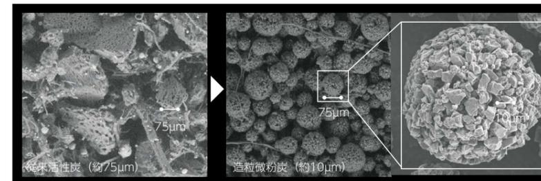
造粒微粉炭の微構造
