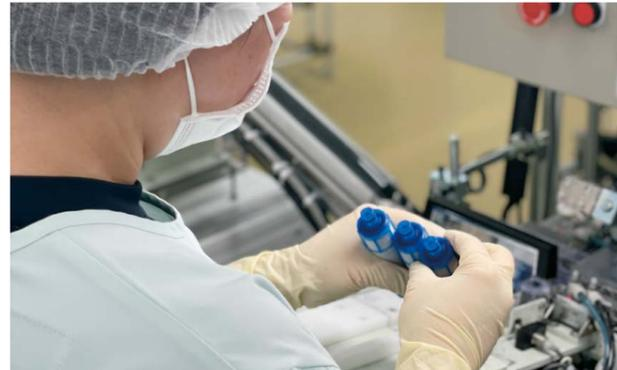
異物の混入を防ぐため、クリーンルームで製造・組立を実施しています。センサーとカメラによるチェックに加えて、人の手による全品検査を実施しています。
