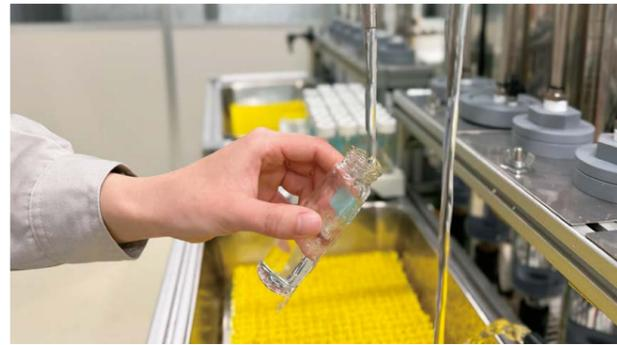
様々な除去対象物を含んだ液体を作り、浄水器を通して採水・分析し、厳密な浄水性能の検証を行っています。
