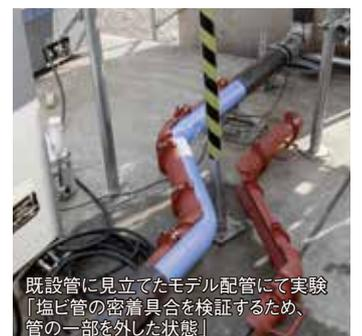
既設管に見立てたモデル配管にて実験「塩ビ管の密着具合を検証するため、管の一部を外した状態」
