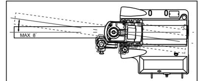
パイプのセットが多少ずれていても、ヘッド部が可動式でパイプに倣って動くため(最大振り角8度)、管端がラッパになりにくい構造になっています。そのため加工精度が大幅にアップしました。
