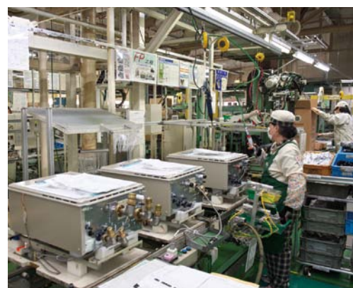
▲熱塗装や板金などの工程もすべて瀬戸工場で一貫加工。部品は1時間ごとにサンプル検査を実施
