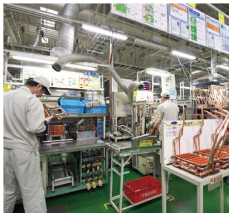
▲熱交換器の溶接工程。洩れのないように2時間かかりで密着させる
