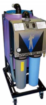
リカバリーフィルター 回収した汚水を凝集剤で放射性物質セシウムを吸着した後、再利用するためのフィルターシステムです。10μのフィルターで瞬時に濾過します。
