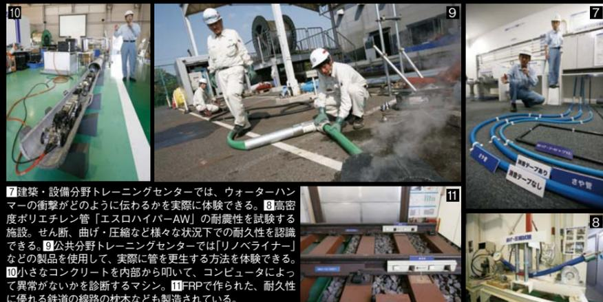
7 建築・設備分野トレーニングセンターでは、ウォーターハンマーの衝撃がどのように伝わるかを実際に体験できる。8 高密度ポリエチレン管「エスロハイパーAW」の耐震性を試験する施設。せん断、曲げ・圧縮など様々な状況下での耐久性を認識できる。9 公共分野トレーニングセンターでは「リノベライナー」などの製品を使用して、実際に管を更生する方法を体験できる。10 小さなコンクリートを内部から叩いて、コンピュータによって異常がないかを診断するマシン。11 FRPで作られた、耐久性に優れた鉄道の線路の枕木なども製造されている。
