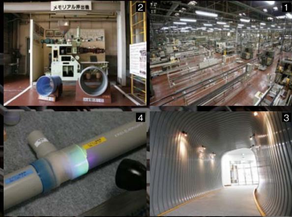
1 押出成形によって生産される塩ビ管。材料や温度調整などに違いはあれど、塩ビ管も更生管も基本的な作り方は同じだ。2 工場内には滋賀栗東工場が開設された1960年当時の押出機も保存されている。3 総合力展示ホールには様々な製品や、それらを使用したモデルが展示されている。これはSPR工法によって更生された配管の内部をイメージして作られたトンネル。4 継ぎ手の部分がいかりシールされているかを確認できるように、ブラックライトで光る接着剤も開発されている。
