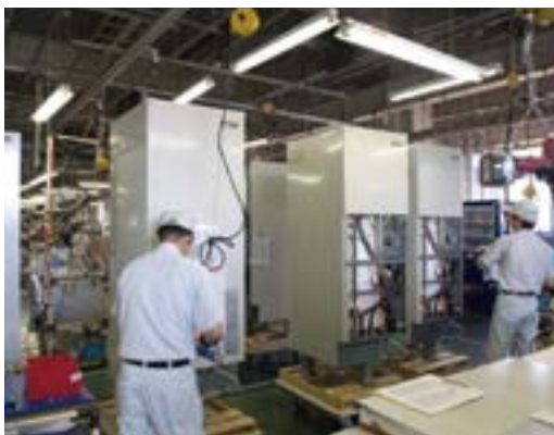
▲貯湯ユニットの外装等を取り付ける
