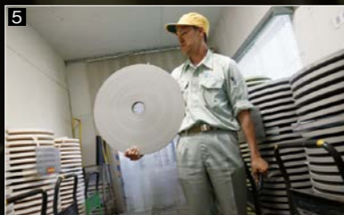
3 インシュレーションボードの製造工程。蒸気で蒸したウッドチップがすりつぶされ、デンブンなどと混ぜられてドロドロとなった原料が網で漉かれていく。4 マット状になったボードはまだ柔らかい状態。ここから長さ100mにわたり、ドライヤーをかけ、乾燥したら完成。5 「ダイケン健やかおもて」の畳表の原料となる和紙ロール。1本で8000~9000mの長さがあるが、畳表にするとわずか2帖分となる。6 重要な検品工程。糸が2本入った部分や結んである部分などを手作業で修正していく。
