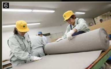
3 インシュレーションボードの製造工程。蒸気で蒸したウッドチップがすりつぶされ、デンブンなどと混ぜられてドロドロとなった原料が網で漉かれていく。4 マット状になったボードはまだ柔らかい状態。ここから長さ100mにわたり、ドライヤーをかけ、乾燥したら完成。5 「ダイケン健やかおもて」の畳表の原料となる和紙ロール。1本で8000~9000mの長さがあるが、畳表にするとわずか2帖分となる。6 重要な検品工程。糸が2本入った部分や結んである部分などを手作業で修正していく。
