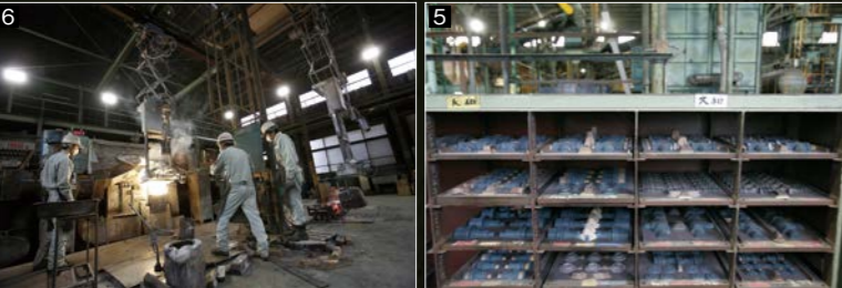
3 砂で作られた型に、内型となる中子をセットしていく。4 鋳肌面を良くする塗型という作業が行われる。5 砂型を作るための型がズラリと並び、赤黄青の三色のラベルは、注湯するときの材料の温度を表している。6 溶解炉で溶かされた材料は1100℃を超える高温。特に夏場は体力を消耗する過酷な現場だ。
