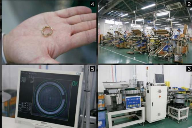
2 少量多品種の生産を行う本社工場では、ライン生産ではなくセル生産方式を採用し、完成組立・梱包まで行っている。3 三層管配管システム「ドライフレックス」用ワンタッチ継手の共通部品は自動機で組み立てられ、各々のセル生産ラインへ供給されている。4 5 継手のパイプの抜け止めを担う部品。加工形状が図面通りに仕上がっているか画像認識で全数検査している。
