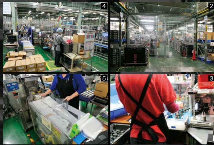
②プッシュマスターを製造するラインは樹脂を扱っている。異物の混入を防ぐために、工場内部にビニールで覆われた専門の作業室が設置されている。③半自動機とよばれる設備では、5つの部品を人が機械にセットし組み立てる。その後の検査は自動で行われる。④作業室には、組立・検査機があり、組立から検査まで完全自動の最新型も稼働している。⑤梱包ラインは2人1組による作業。単純な作業のように見えるが、実は熟練の技が光るポイントだ。
