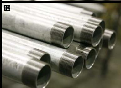
8 溶接されたパイプはワイヤーできたたわして研磨され、余分なものが落とされる。9 溶接面のサビ止めや、ねじ接合部のシール材はすべて手塗り。グルーピングの養生なども手作業で行われている。10 自動切断機で加工されたパイプは、自動的にコードも印字可能。11 12 ねじ切りは半自動化されている。JIS規格に適合するよう、どこまでねじが入っているか、山がきちんと立っているかといったことがゲージですぐに検査される。13 ドレンを受けるホッパーなども製造している。
