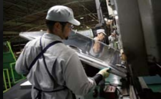
3 平板をパンチング加工するターレットパンチプレスに使用される金型は約100種類にのぼる。4 2台の巨大なプレス機。「第1絞り」と呼ばれる600トン、「第2絞り」の1,500トンで成型される。5 最新鋭のファイバーレーザー加工機。排水口の部分を抜き取ったり、外周を切り取ったりといったトリム加工のほか、細かい穴を空けるピアス加工も行われる。6 曲げの加工は職人の技が光る。
