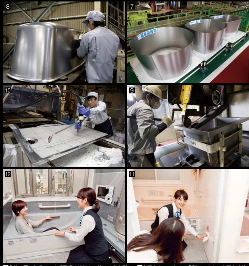
7浴槽の胴の部分は、まず平板を溶接して筒のような形に。8上面をカールさせて成型し、さらに底面を溶接。9取り付け手すりには人間の手で研磨を行う。微妙な感覚が必要な、職人の仕事だ。10洗い場パンには素焼きのタイルが張られる。目地埋めはまるで左官職人のような職人作業だ。11タカラスタンダードのショールームは全国170か所。12地方都市にも数多く存在しているため、気軽に見学することができる。
