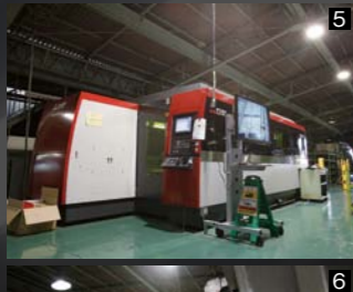
3 平板をパンチング加工するターレットパンチプレスに使用される金型は約100種類にのぼる。4 2台の巨大なプレス機。「第1絞り」と呼ばれる600トン、「第2絞り」の1,500トンで成型される。5 最新鋭のファイバーレーザー加工機。排水口の部分を抜き取ったり、外周を切り取ったりといったトリム加工のほか、細かい穴を空けるピアス加工も行われる。6 曲げの加工は職人の技が光る。
