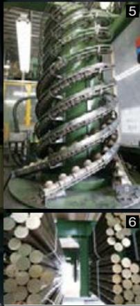
3 茅野工場が採用するかんばん方式の「かんばん」。この中に、製造する製品のデータが細かく記載されている。4 青銅バルブは灰色の砂型と栗色の中子の間に材料が流し込まれて作られる。5 自動バリ取り機への素材供給装置。6 黄銅バルブの材料。
