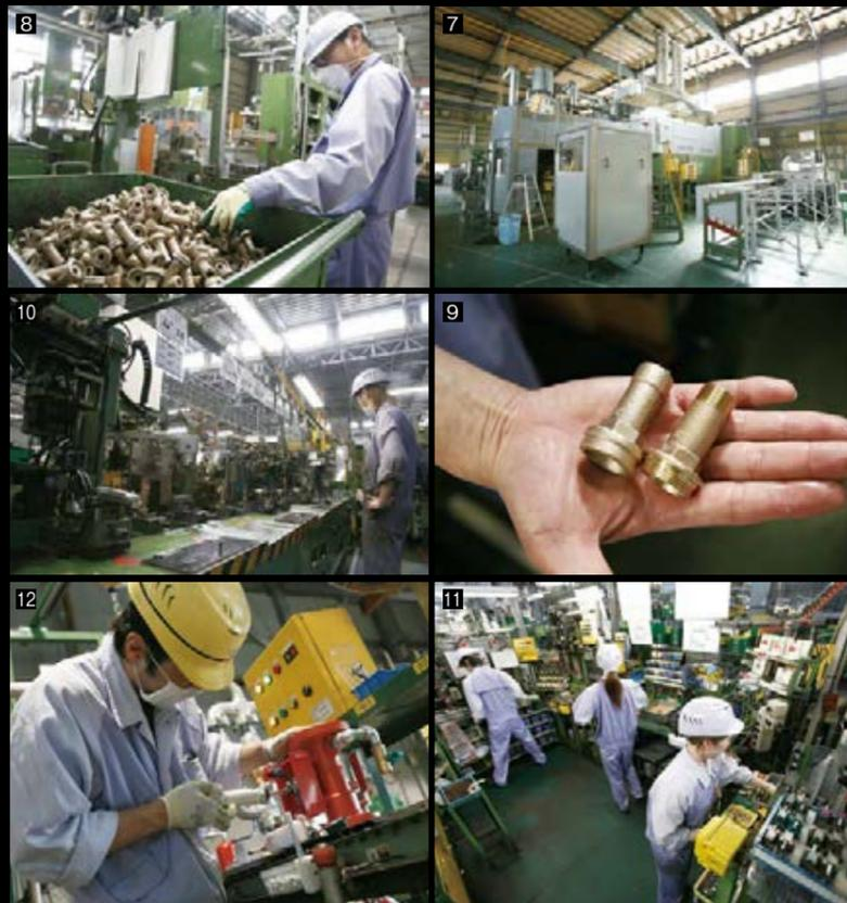
7 イタリア製の最新鋭プレス機によって材料が熱せられ、プレスされる。8 黒ずみやバリを取り、磨き上げる仕上げの工程。9 10 内外が削られ、ねじ切りまで行われた部品は、ほかのパーツと組み立てられる。青銅バルブを加工し、組み立てる工程はほとんどが機械による自動作業。11 最後の圧力検査は全数を行う。12 消防設備用バルブについては毎週火曜に消防安全センターが認定のために来社。特に高い品質管理が求められる製品だ。
