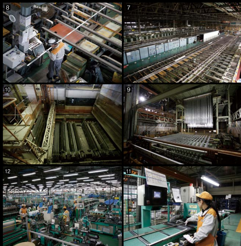
7 押出工程で成形された型材。押し出しながら長いベルトコンベアで運ばれ、およそ45mの長さとなる。8 冷却されたら、長い型材が必要な長さに切断する。6mほどになることが多い。再び焼き入れ（エージング）を行い、表面処理工程へ。9 巨大な型枠とクレーンに6mの長さの型材が簾のように取り付けられ、運ばれる。10 表面処理を行う様々な電解槽へ型材を浸け込む。時間などは商品に合わせて、自動的にプログラミング。11 型材は加工工程で、使用する長さに再カット。12 加工や組立、検査、梱包などはひとりの担当者が一貫して行う。
