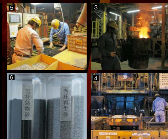
3 鉄屑は電気ですべて6トンずつ、1500℃以上に溶かされる。これをラインに供給するために1200kgずつに取り分けられ、それぞれ運ばれる。 4 造型工場では巨大な鑄造造型機によって上型と下型が作られる。ここでは1/2～6インチの継手が作られている。 5 砂型に中子（中型）を入れる。隙間の部分に溶湯が流し込まれていく。 6 使用した鑄型の砂は、自社開発の鑄物砂再生装置で焙焼することで、真っ黒な砂がきれいな灰色の砂に再生され、中子の原材料としてリサイクルされる。
